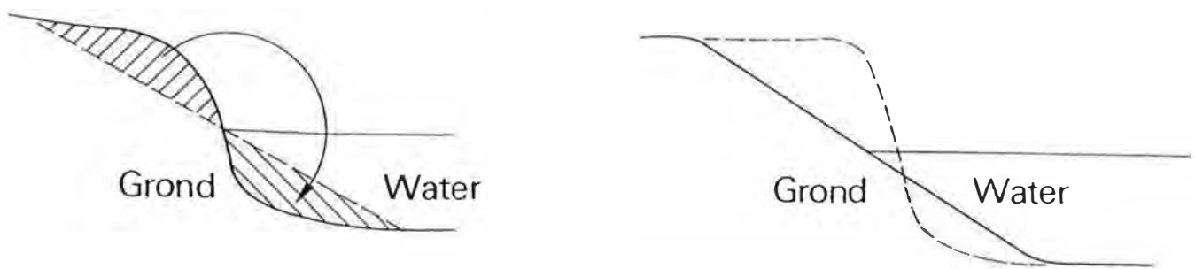
Figuur 8.7: Afgraven van oostelijke en westelijke oever; profiel.
